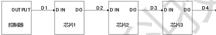
其中D1为控制器发送的数据，D2、D3、D4为级联TM1803转发的数据
