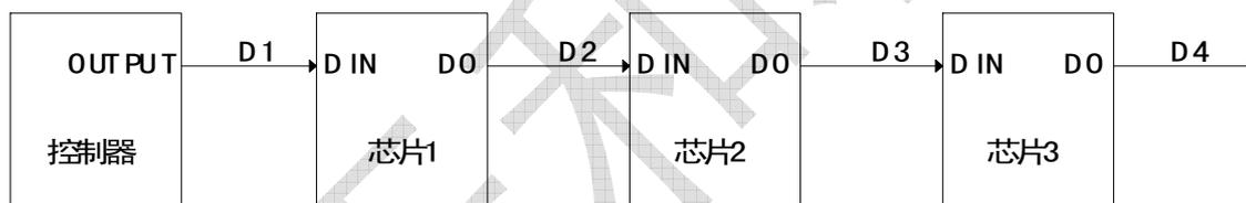
其中D1为控制器发送的数据, D2、D3、D4为级联TM1812转发的数据
